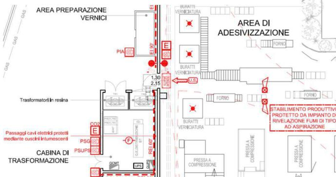
L'area produttiva è stata dotata di impianto di rivelazione ad aspirazione, un impianto di estinzione ad idranti e un impianto di riscaldamento a nastri radianti. Gli impianti elettrici sono stati completamente riprogettati, a partire dalla cabina elettrica di trasformazione. Analogamente, anche l'impianto termotecnico è stato rivisto del tutto, dalla centrale termica alla distribuzione.
